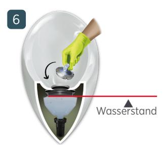
6 Wasser bis zum Überlauf auffüllen und Deckel in die Öffnung des Urinals einsetzen.
