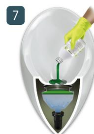
7 Sperrflüssigkeit uriLOCK (300 ml) über den Deckel leeren.
